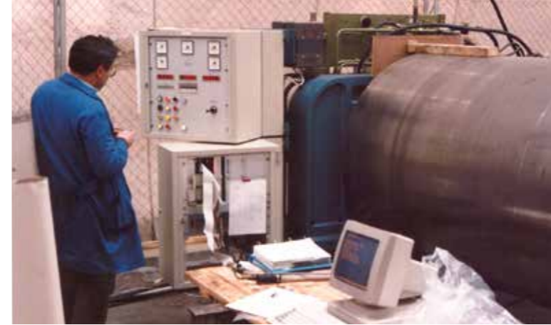
#inBewegung in Sachen Digitalisierung und Automatisierung war Berndorf Band schon 1986. Wolfgang Haidvogel kontrolliert die digitale Bandspann- und Regeleinrichtung basierend auf Echtzeitrechner.
