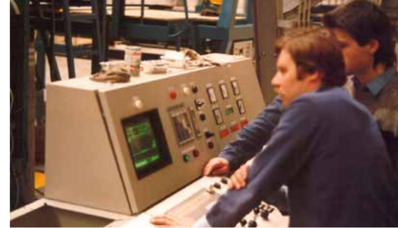
Roland Schuster (hinten) und Richard Rotleitner (vorne) arbeiten mit dem Vorreiter des heutigen Machine Learnings. Der über ein Bussystem verbundene Leitreechner übermittelt alle Qualitätsdaten und errechnet die bestmögliche Lösung für die Bandproduktion.
